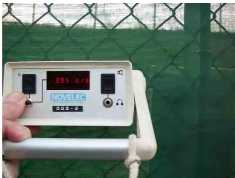
Mesure du flux de rayonnement gamma au point C7, clôture FBFC / CRIIRAD, novembre 2007
