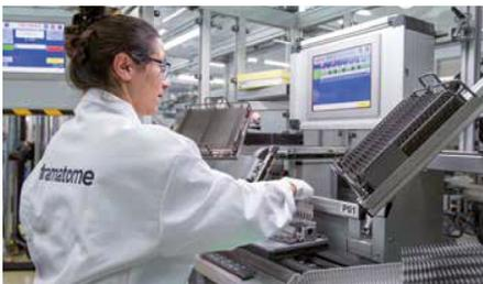
■ **La grille** assure le positionnement et le maintien des crayons. Elle doit aussi faciliter le transfert de chaleur entre l'assemblage et l'eau du réacteur.
