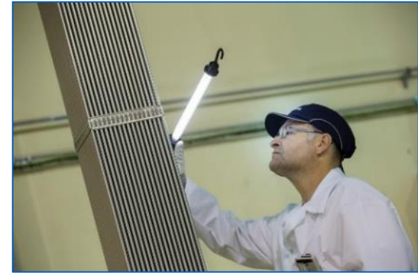
Contrôle visuel d'un assemblage
