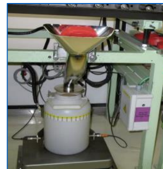
Pesage en continu du bouteillon de pastilles d'uranium
