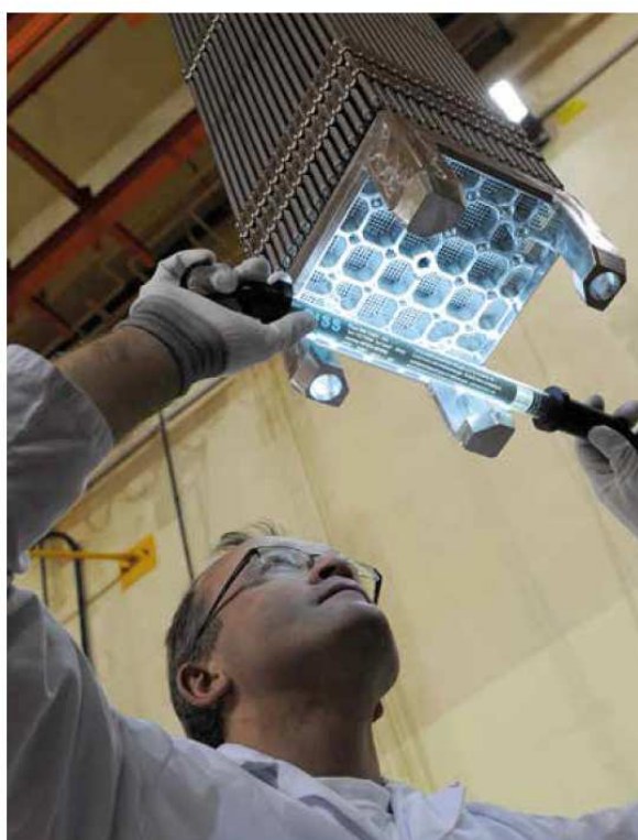
Contrôle visuel d'un assemblage combustible
