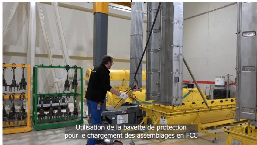
Utilisation de la bavette de protection pour le chargement des assemblages en FCC
