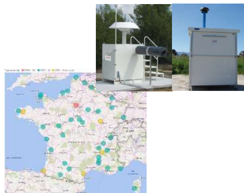
Le réseau Opera Air Préleveurs aérosols (# 40 80 m 3 /h + 7 très bas niveau 700 m 3 /h)
