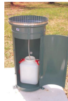
Collecteur d'eau de pluie
